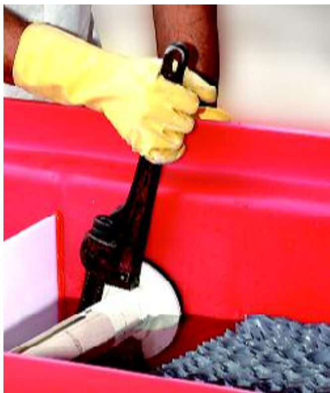
FIGURA 10 - Operador despertando os flanges internos
