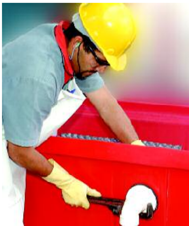
FIGURA 12 - Operador despertando os flanges externos
