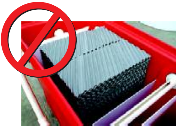
FIGURA 22 - Uso incorreto das placas coalescentes
